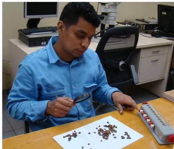
Figura 5: Método de Conteo de Partículas con Lupa.
