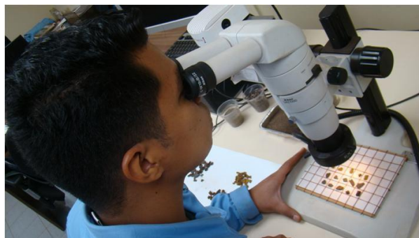
Figura 6: Método de Conteo de Partículas en un Amplificador de Imagen.
