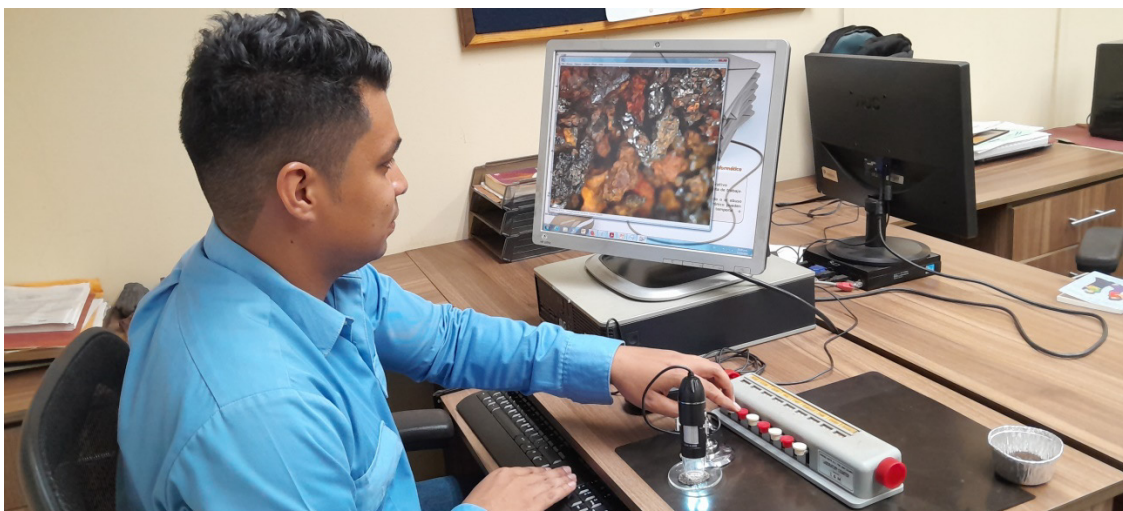
Fig. 3. Conteo de partículas en imagen tomada con el microscopio digital USB.
