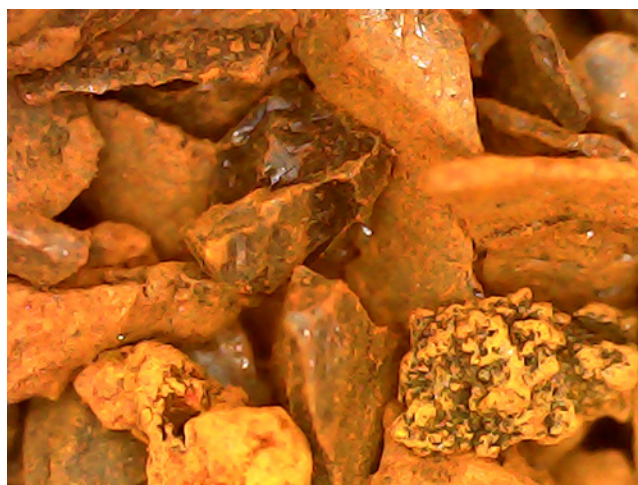
Fig. 6. Imagen de especie litológica costra goethítica vitriosa en muestra de la fracción de 10 malla con un aumento 25X.
