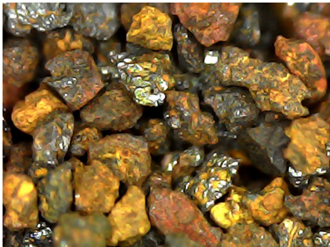
Fig. 7. Imagen de la muestra de mineral de hierro de la fracción de 100 malla para el conteo de partículas con un aumento de 150X.
