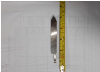
Figura 3: Cuchilla de acero rápido (HSS) usada en el cilindrado, para evaluar su desgaste. Fuente: Romiplast C.A.
