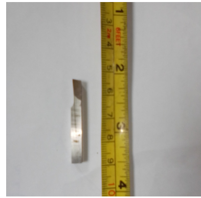
Figura 4: Cuchilla de acero rápido (HSS) usada en el Refrentado, para evaluar su desgaste. Fuente: Romiplast C.A.
