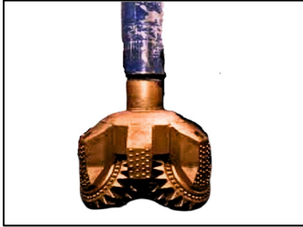
Figura 3 Conjunto sarta petrolera con broca de perforación
