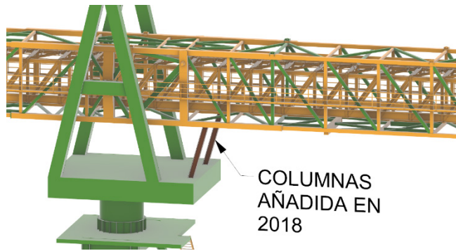
Figura 3: Sistema estructural al momento de la falla
